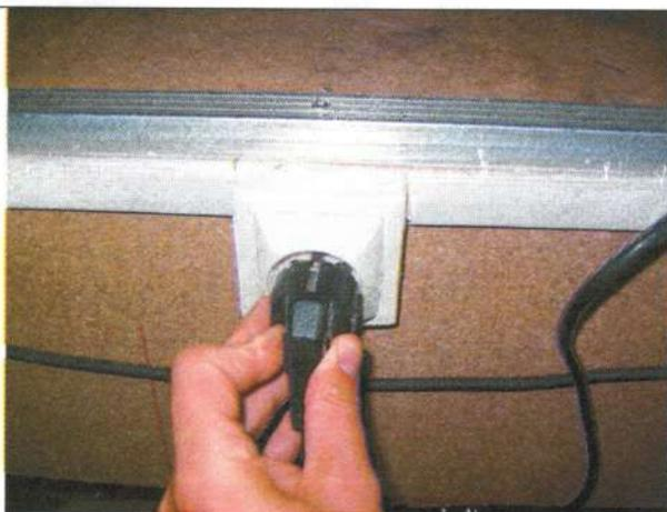
5. Brancher l'autre extrémité du câble d'alimentation sur une prise.
