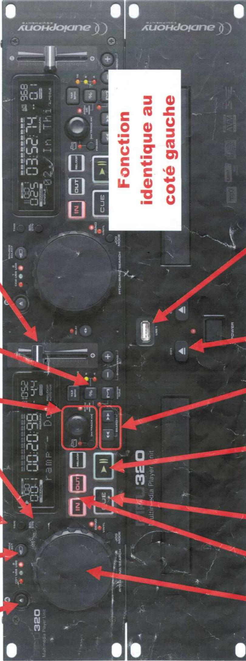
Mettre sur AUX pour utiliser un ordinateur par sortie audio
